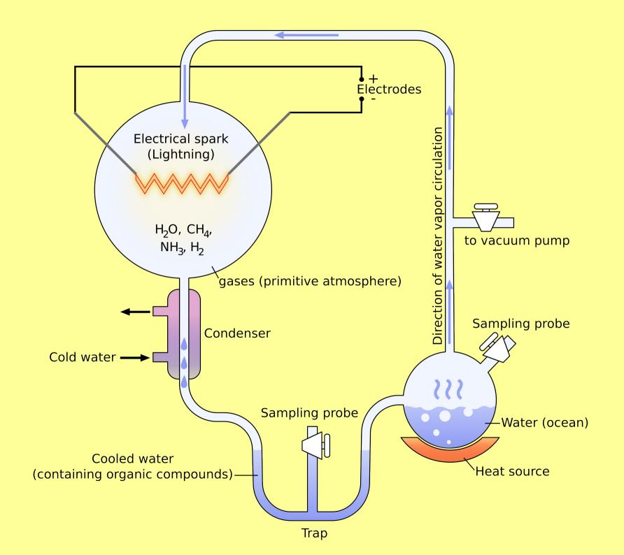
→ Água (H₂O), metano (CH₄), amônia (NH₃) e hidrogênio (H₂) foram isolados dentro de um frasco conectado a outro frasco, contendo água em estado líquido.
